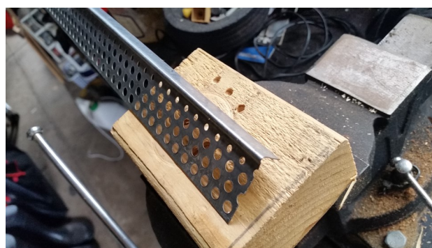
Plaster board edge strip
